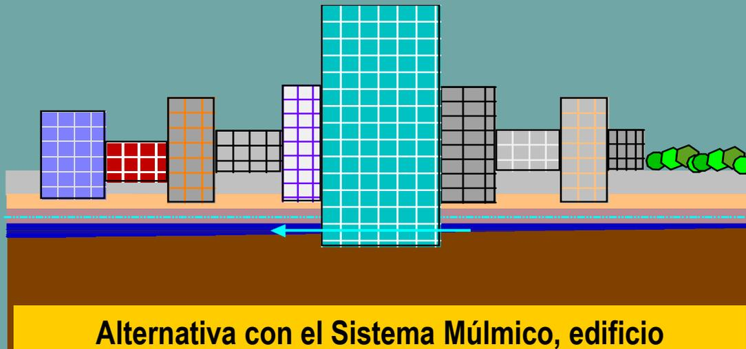
**Alternativa con el Sistema Múltimo, edificio permeable que mantiene la continuidad del acuífero.**
