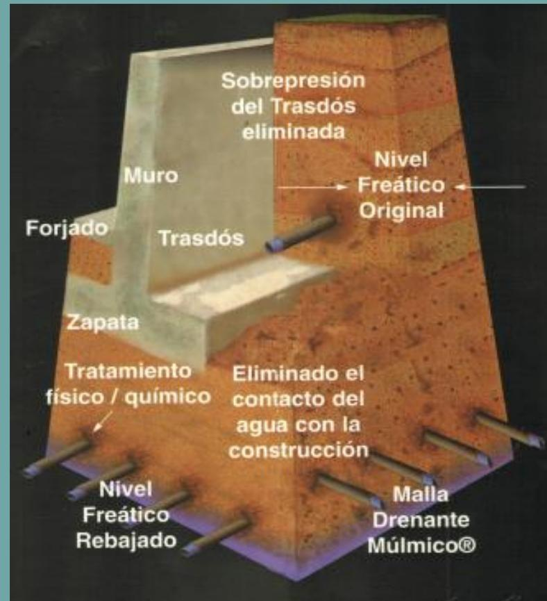
Con la inserción en el subsuelo de los micro-filtros, su adecuada cuantía, distribución, tipo, etc., se consigue capturar el agua que afecta a la edificación eliminando de raíz el problema. ¡Si no hay agua no hay humedad!
